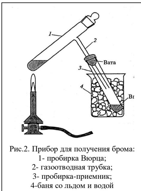
Рис.2. Прибор для получения брома:
