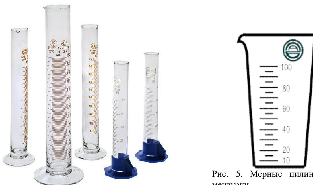
Рис. 5. Мерные цилиндры и мензурки
